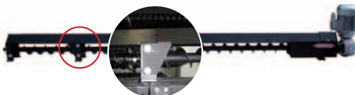
Fig. Las bridas no pueden bloquear el tornillo sin fin.
