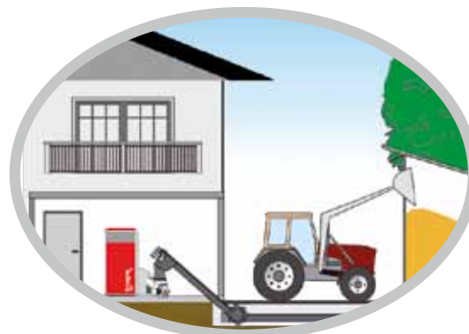
Longitud posible del canal del tornillo sin fin superior a 12 m (varios componentes).
