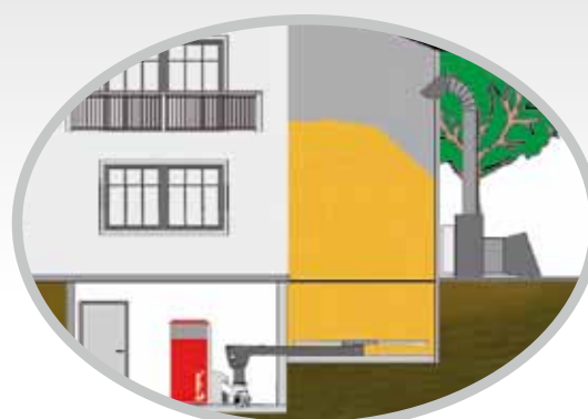
Llenado del depósito con ventilador..
