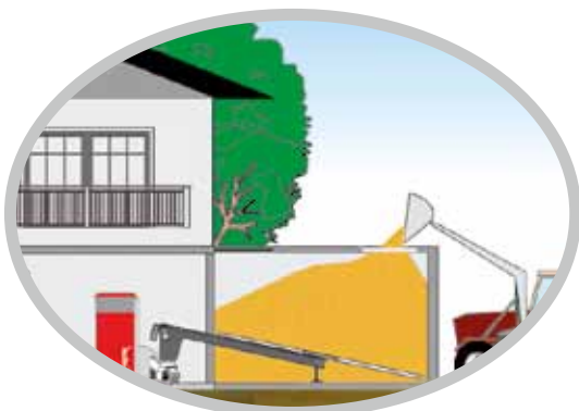
Llenado del depósito con cargador frontal.
